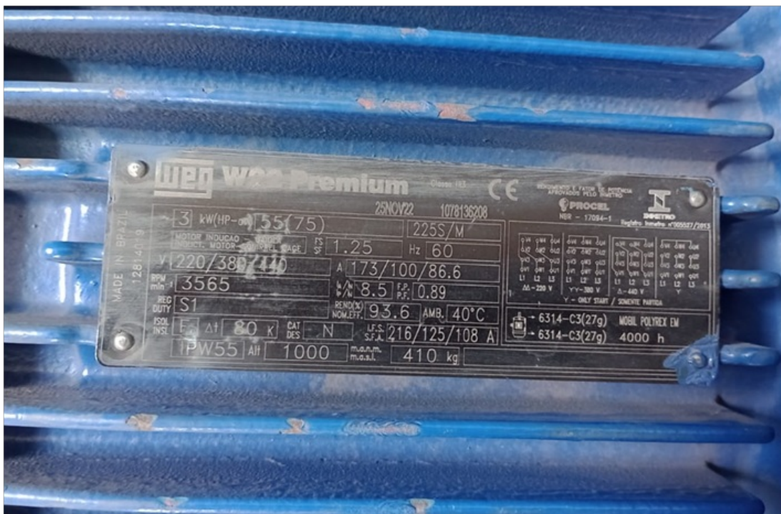
Foto 3 – Informações técnicas da bomba
