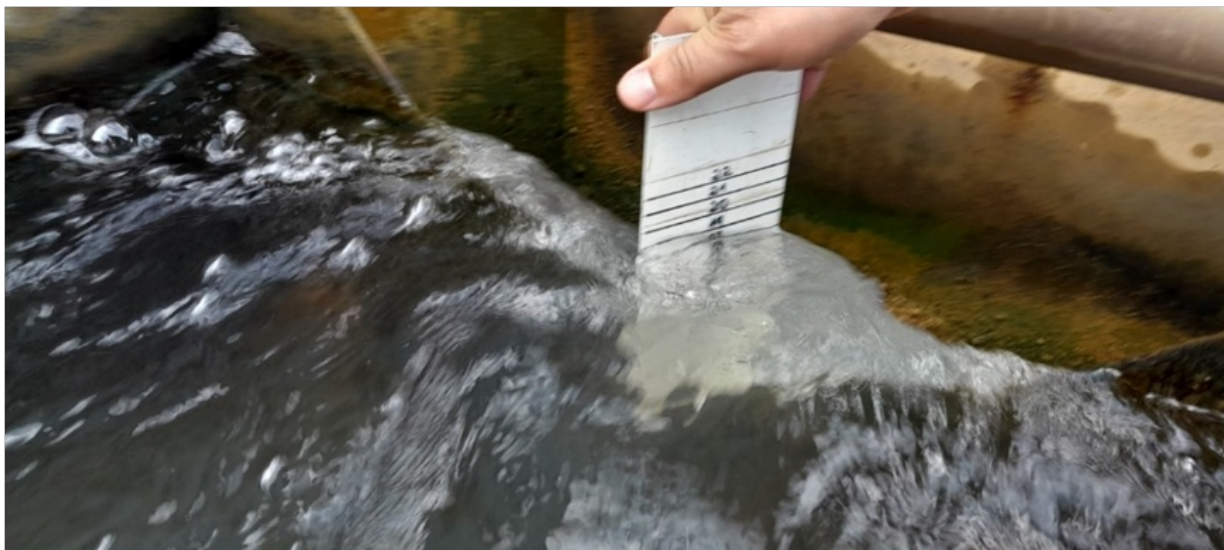
Foto 5 Medição de vazão realizada de forma Manual
