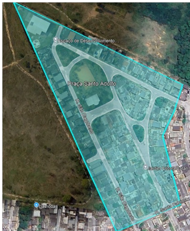
Figura 1 – Região abastecida pela EEAT São Dagoberto
