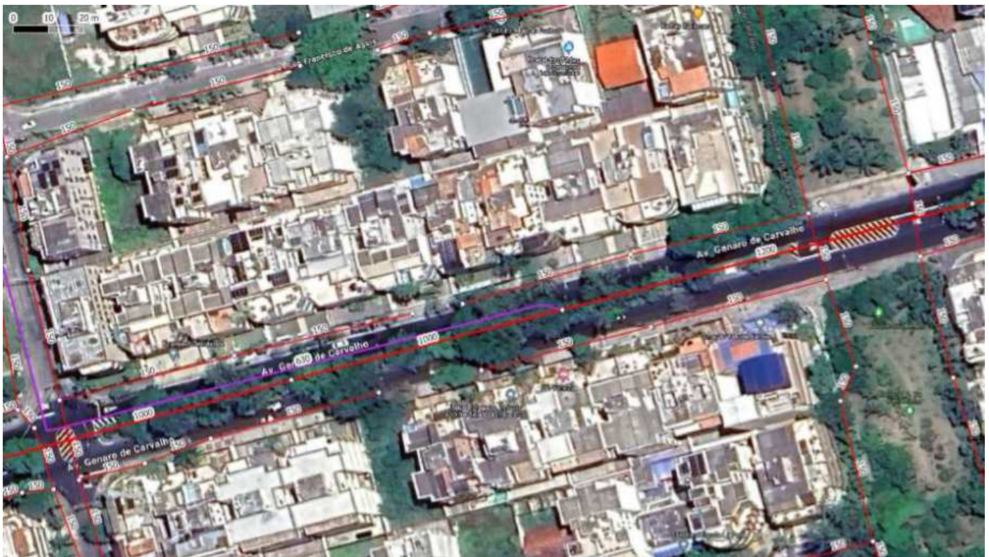
Fig. 2. - Cadastro de esgotamento sanitário na Região 1 enviado pela CEDAE. A rede de esgotamento está em vermelho e a linha de recalque em roxo.
