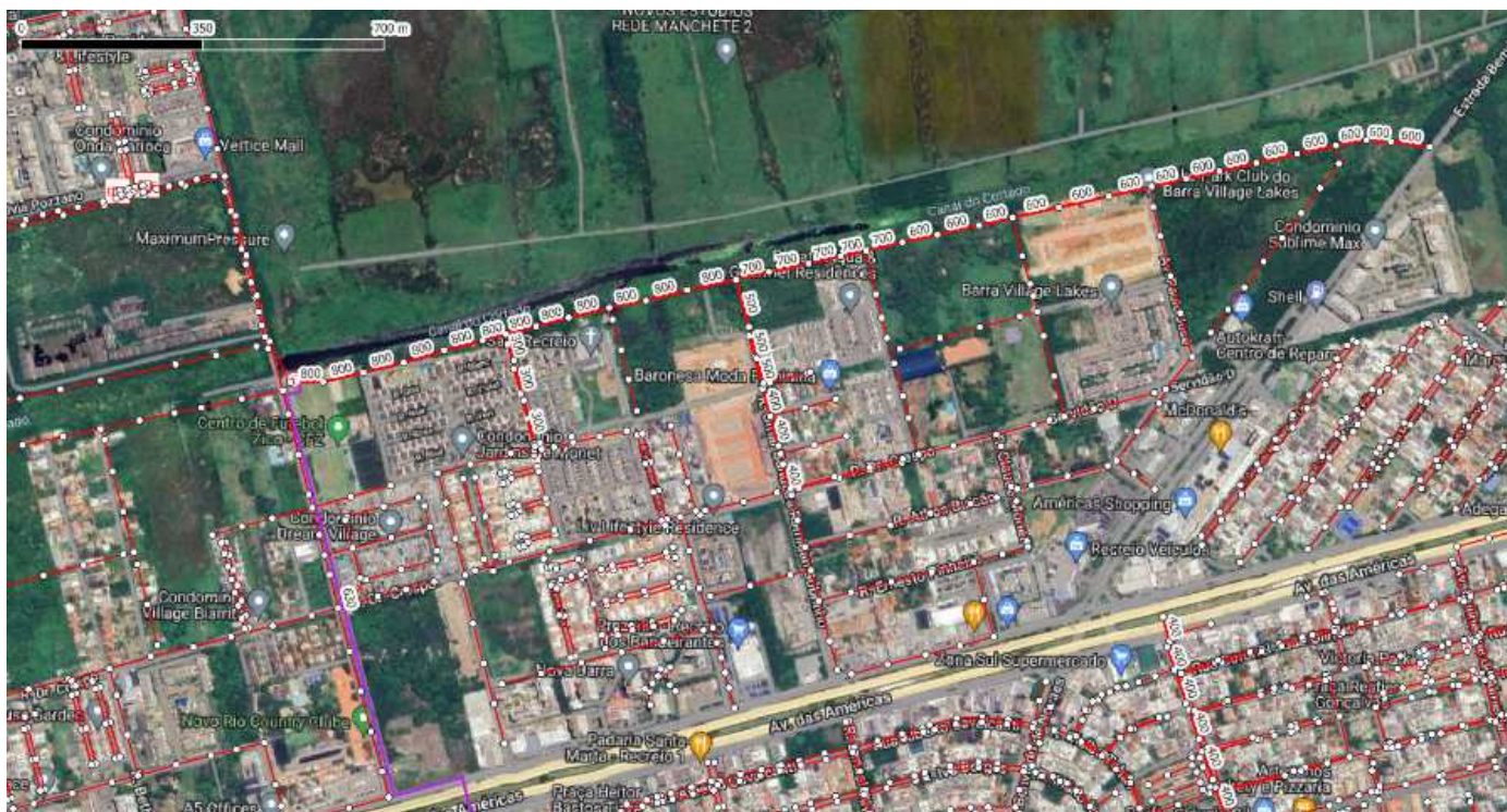
Fig. 8. - Cadastro de esgotamento sanitário na região 2 enviado pela CEDAE. A rede de esgotamento está em vermelho e a linha de recalque em roxo.
