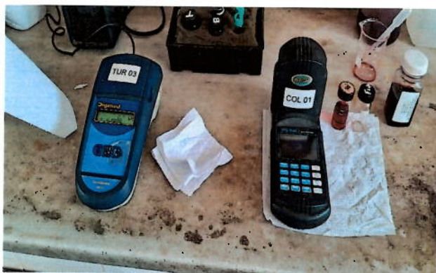
Foto 96: Sala de controle operacional – medição de cor e turbidez.
