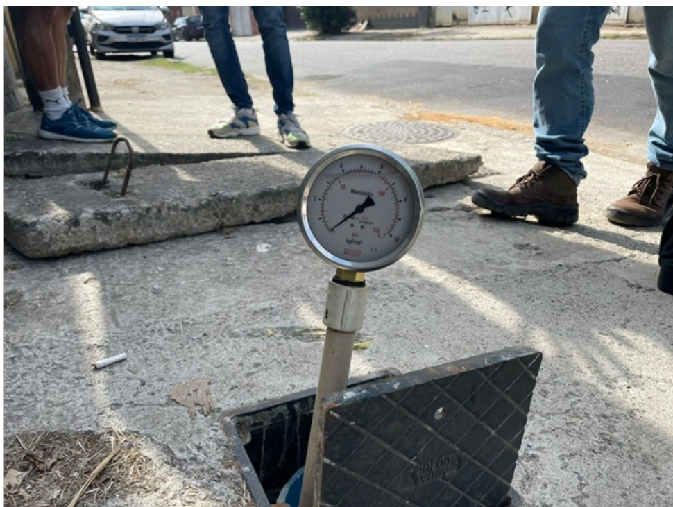
Foto 5 - Manômetro aferindo medição de retaguarda.
