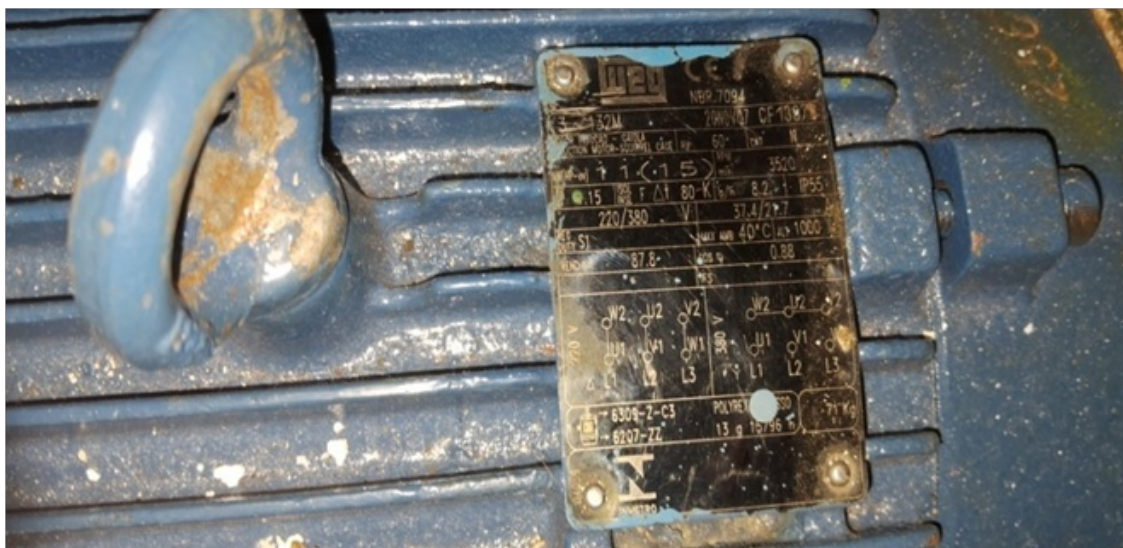
Foto 12 – Plaqueta indicamndo a especificação da motobomba
