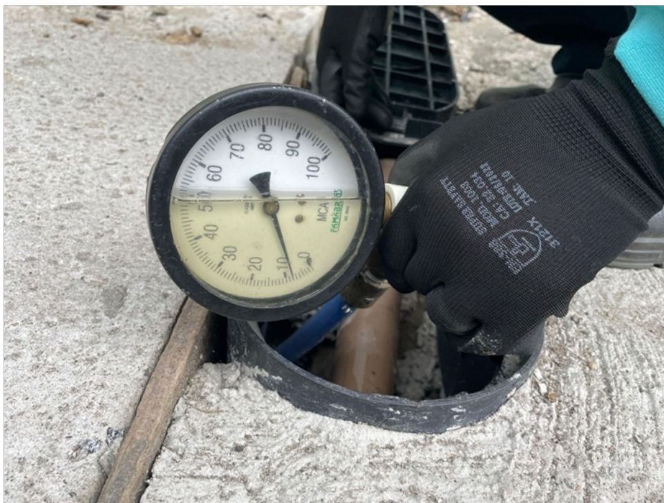
Foto 4 - Manômetro medindo a pressão de retaguarda.
