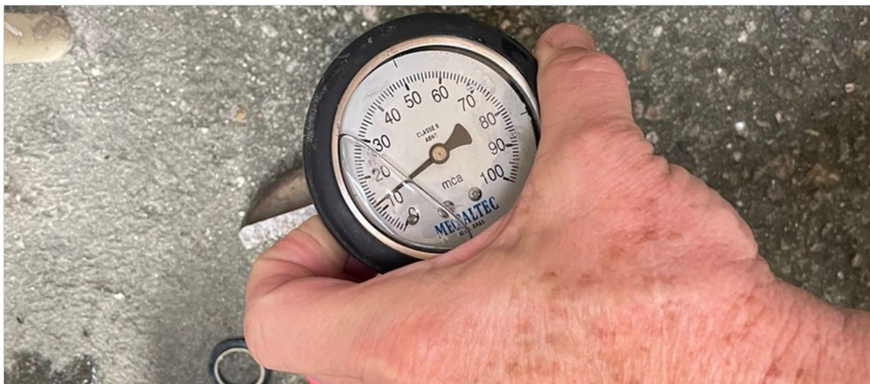
Foto 6 – Pressão manométrica medida no imóvel nº 87 casa 1 no momento da vistoria : 12 MCA
