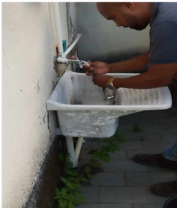
Foto 4 e 5 - Pressão manométrica medida no imóvel nº 12 da rua Ema (30 MCA).
