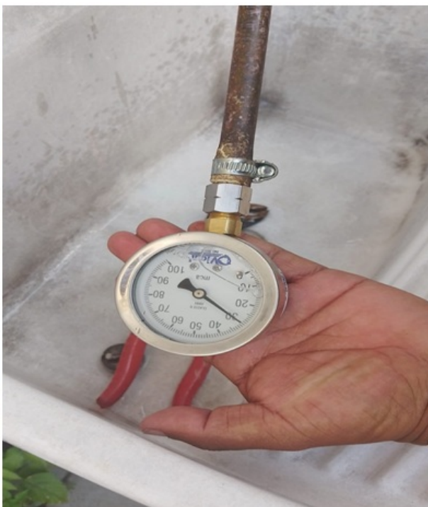
Foto 4 e 5 - Pressão manométrica medida no imóvel nº 12 da rua Ema (30 MCA).
