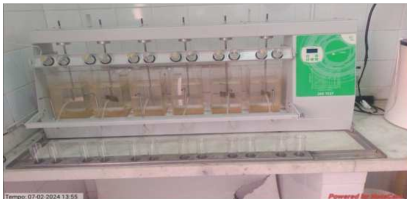
Foto 9 – Equipamento Jar Test para ensaio de floculação.
