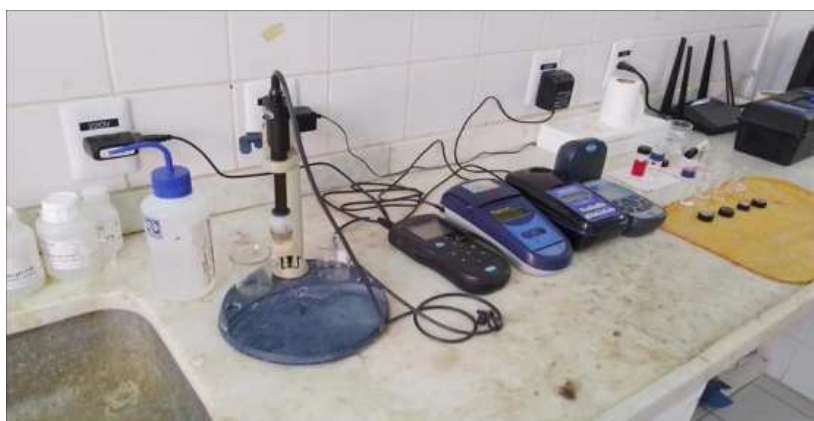
Foto 10 – Equipamentos de medição de parâmetros de potabilidade.
