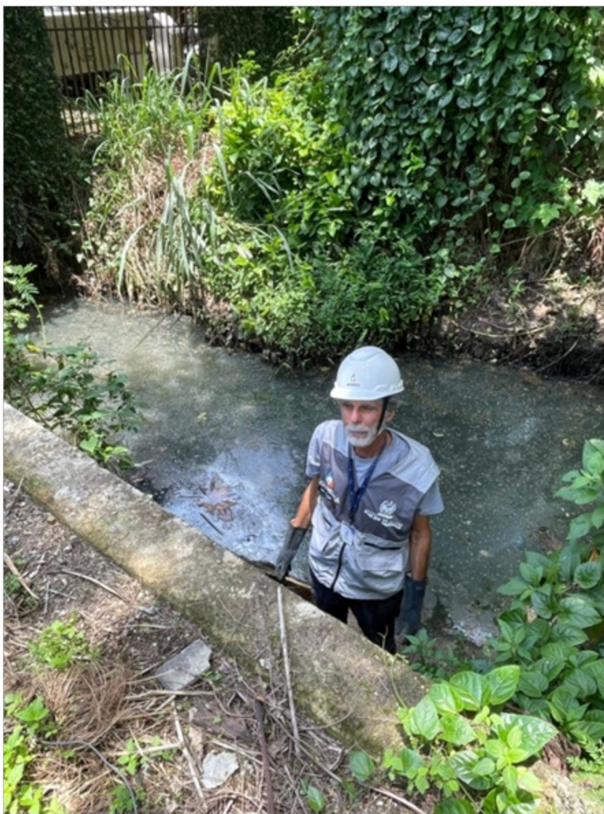
Figura 5 - Equipe de vistoria verificando se existia extravasamento do corante lançado.
