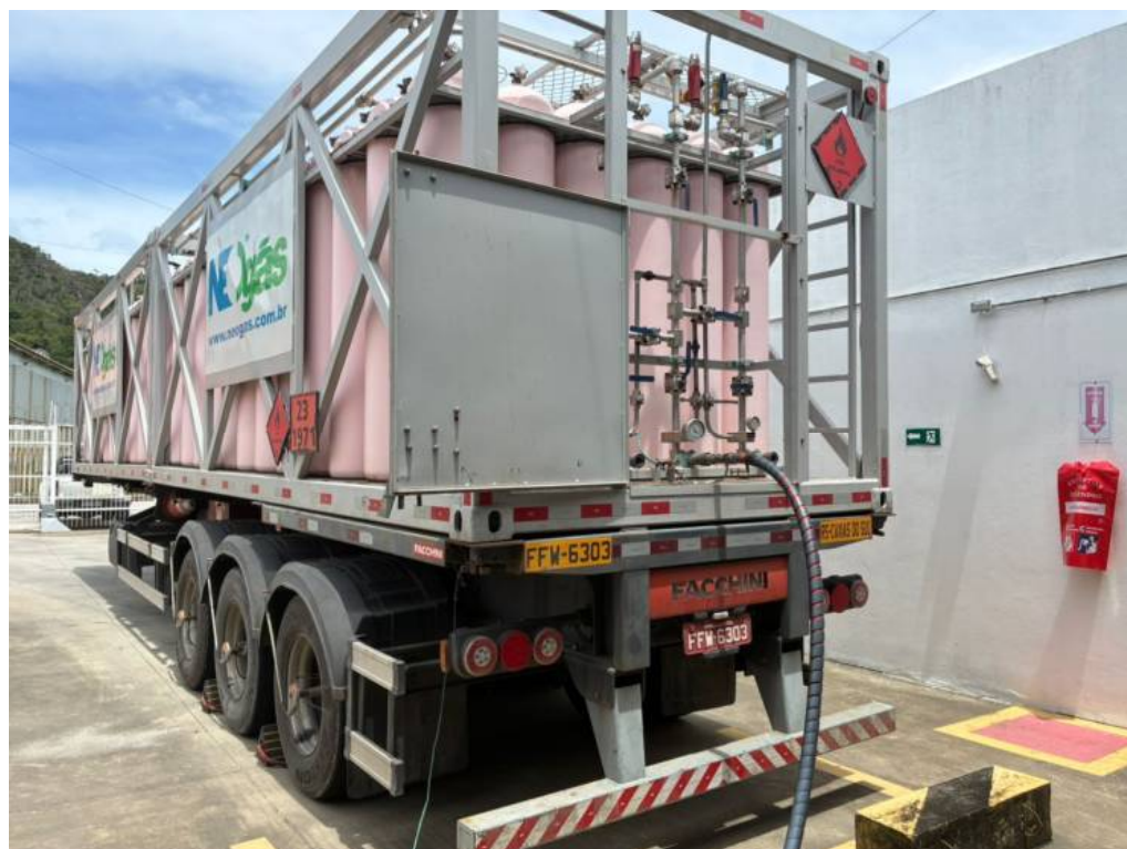
Foto 4: Carreta da NEOgás com cilindros em processo de descompressão.
