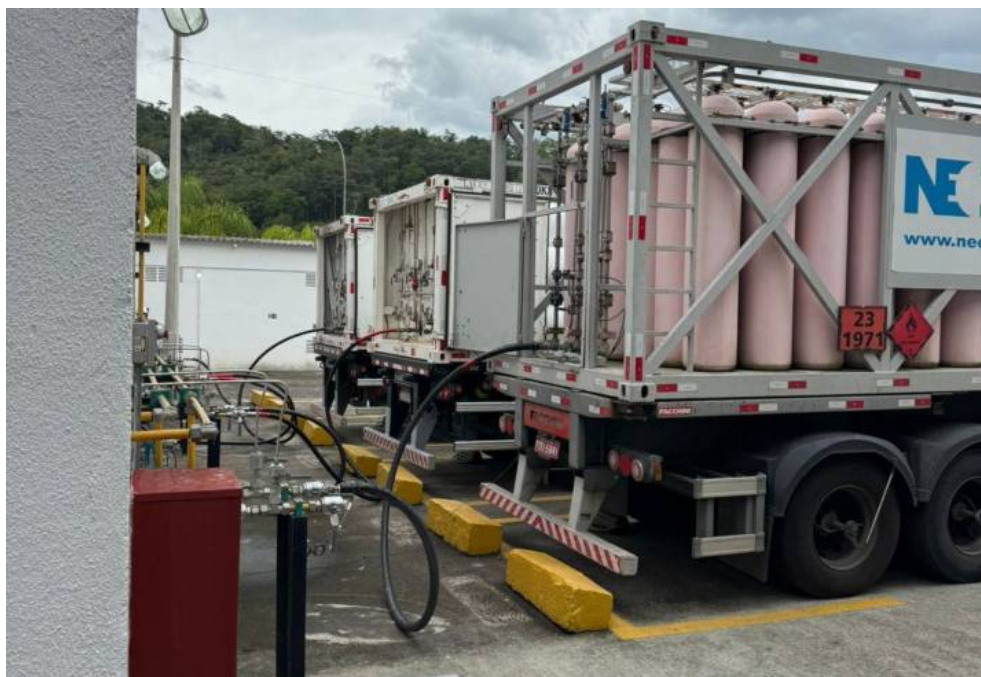
Foto 7: Condução do gás comprimido para os cilindros nas carretas.
