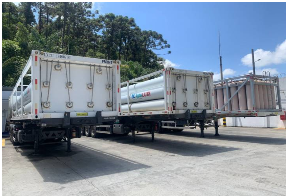
Foto 12: Carretas de transporte de gás natural comprimido (GNC) utilizadas no abastecimento.
