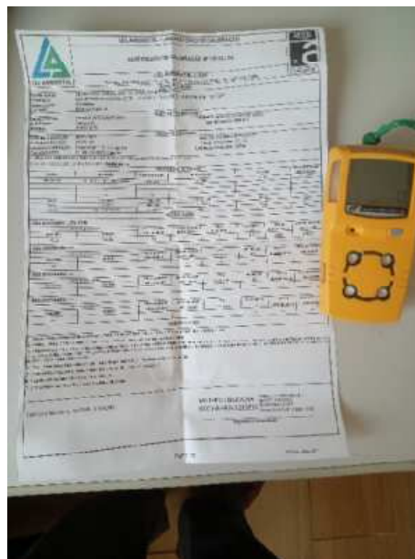
Foto 6: Detector de gás do operador e certificado de calibração.
