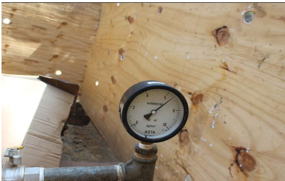
Foto 5: Manômetro utilizado no teste de estanqueidade da rede.
