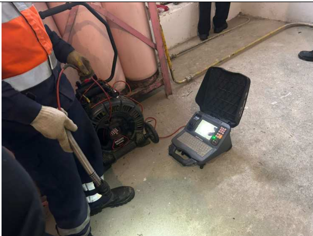
Foto 7: Equipamento de vídeo inspeção utilizado pela Concrejato.
