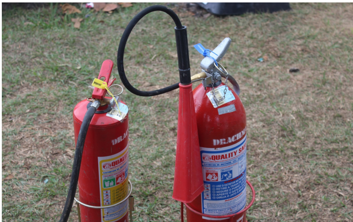
Foto 16: Extintor de Pó Químico e CO2
