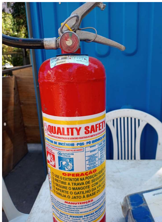
Foto 6 : carga de pressão fora da especificação e novo extintor
