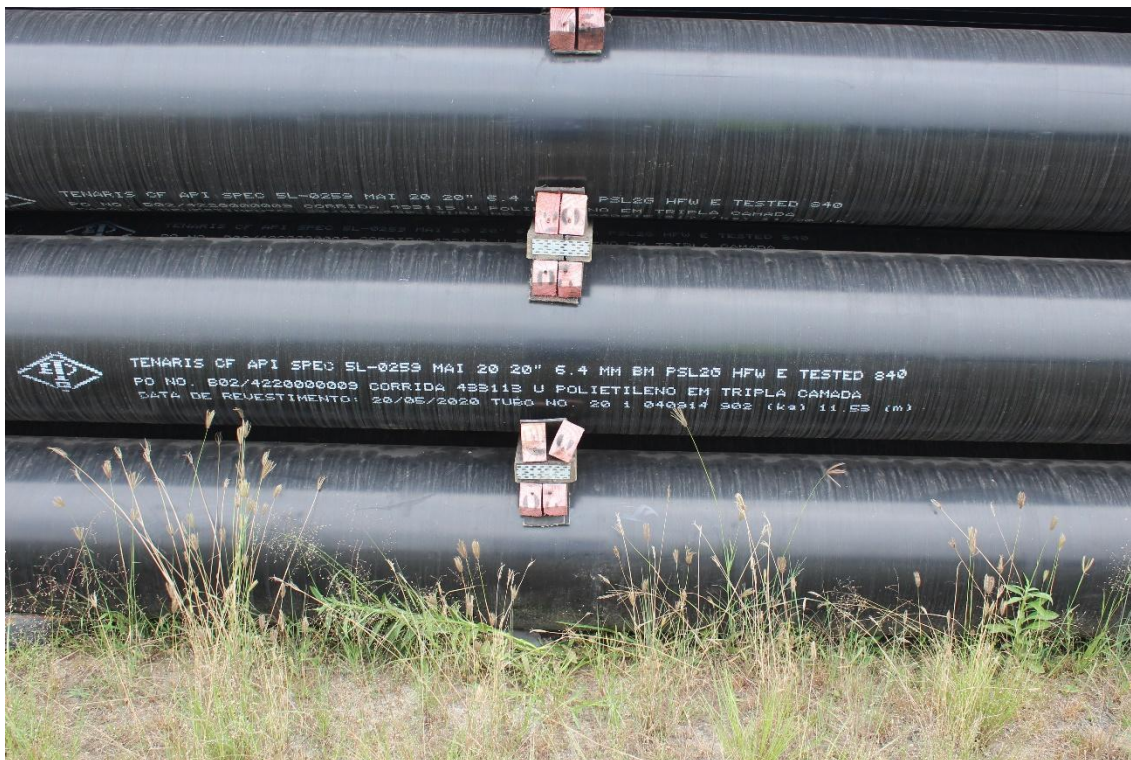
FOTO 28: Identificação dos tubos similares aos que foram danificados no incêndio.
