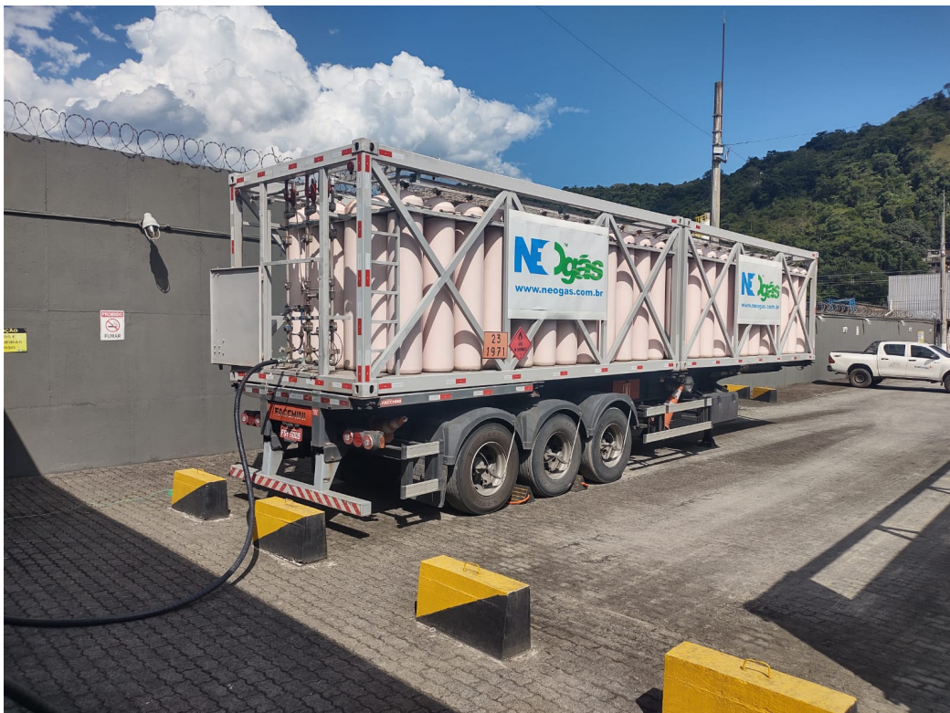
Foto 2: Carreta usada no transporte de cilindros verticais de GNC, a uma pressão de 250 bar.
