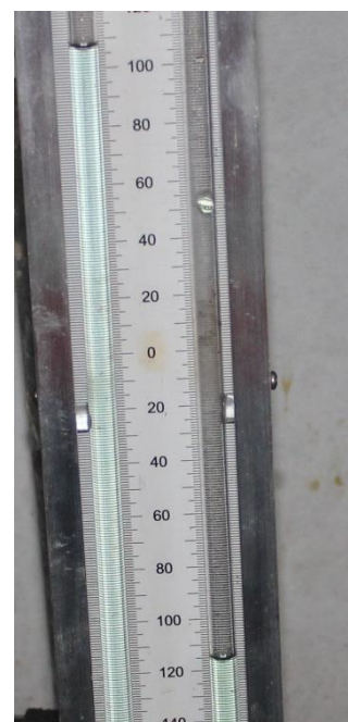
FOTO 6: Pressão inicial do teste de estanqueidade, 220mmCA.
