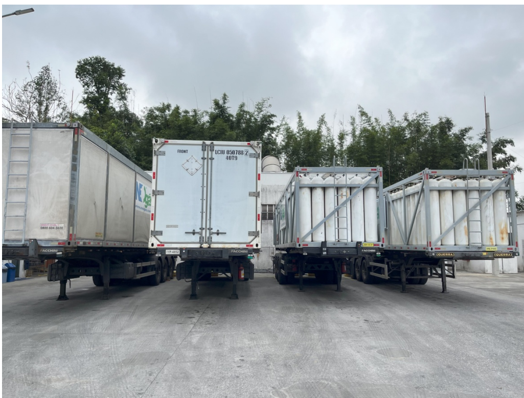
Foto 4: Carretas com cilindros a serem recarregados.
