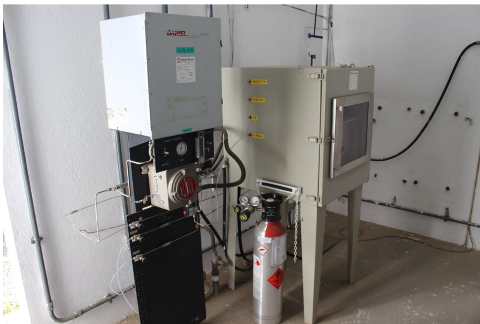
Foto 11: Sistema de Cromatografia para análise da composição do gás.
